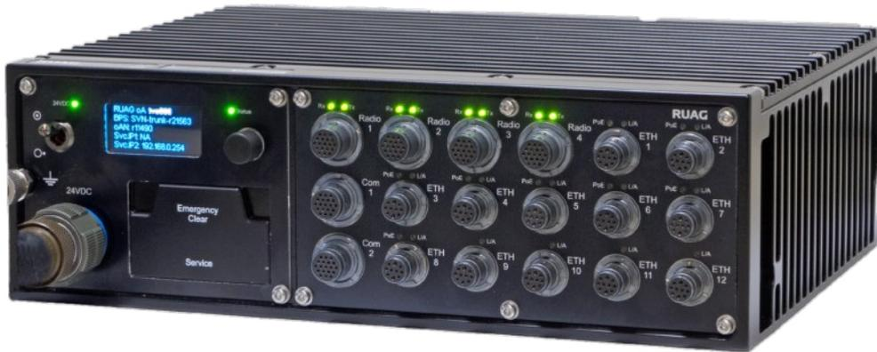
➤ **RUAG TVS** sind taktische Kommunikations-Switches, welche gleichzeitig mehrere Funktionen bei praktischen militärischen Kommunikationsszenarien erfüllen. Sie ermöglichen zuverlässige Sprach- und Datenkommunikation zwischen strategischen, öffentlichen und vorhandenen Netzwerken. Interoperabilität und nicht-hierarchische Vernetzung gewährleisten eine effektive Kommunikation auf allen Ebenen.
