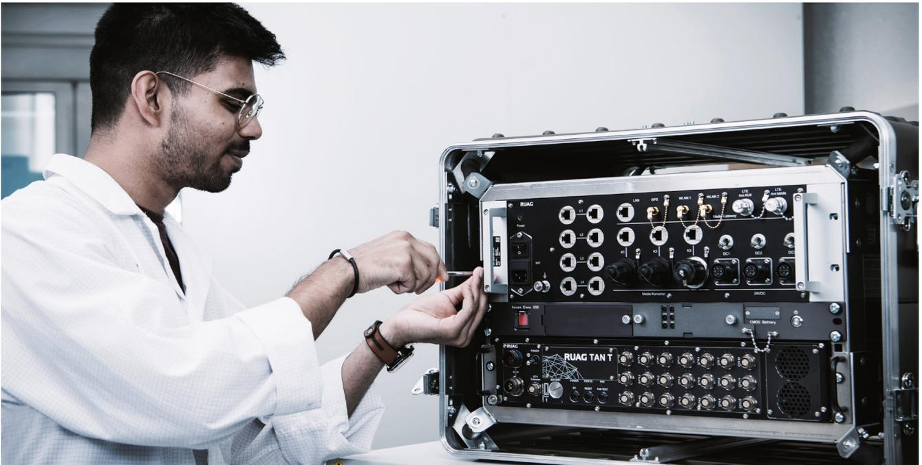
➤ Die integrierten Sprach- und Datenrouter **Tactical Access Node [TAN]** und **Tactical Vehicle Switch [TVS]** von RUAG ermöglichen die interoperable Konnektivität zwischen Kernnetzen, Kommandozentralen, separaten Führungsanlagen und taktischen Mobilfunknetzen.
