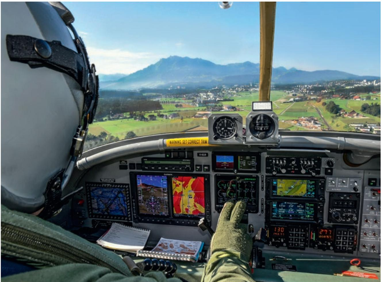
Blick ins modernisierte Cockpit im Anflug auf Emmen. Die neue Avionik ermöglicht präzise Satellitennavigationsverfahren.
